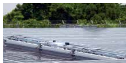
大型洗浄機* (工期:2日間/MW)
