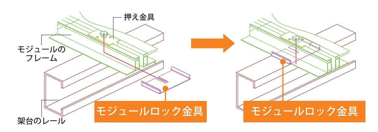
負荷重(逆風)によるモジュールフレームの回転移動を 抑制し、押え金具の変形や長穴加工部の破損を防ぐ
