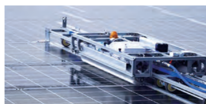
小型洗浄機 (工期:3日間/MW)
