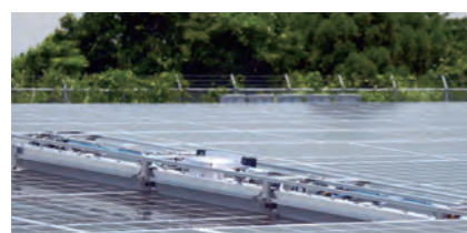
大型洗浄機* (工期:2日間/MW)
